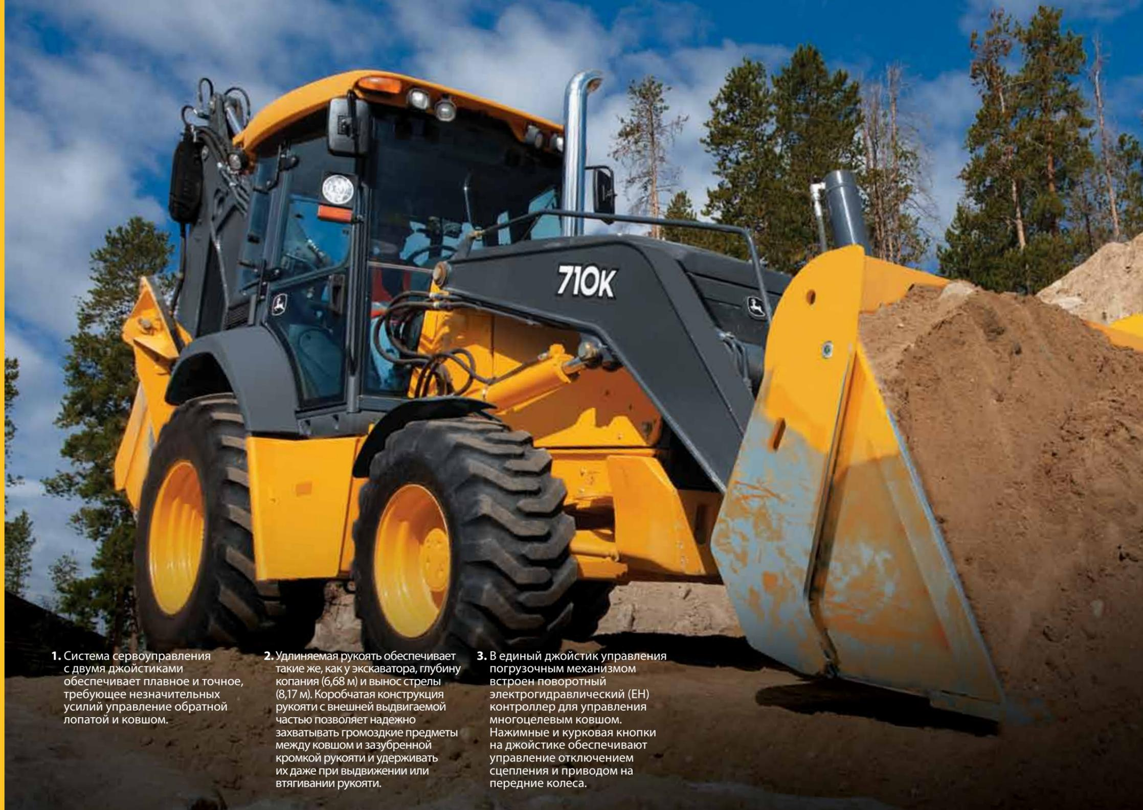
Внушительный запас по крутящему моменту, оптимальное соотношение грузоподъемности и рабочего хода, а также вырывное усилие в 73 кН делают модель 710K мощным и высокопроизводительным погрузчиком.
