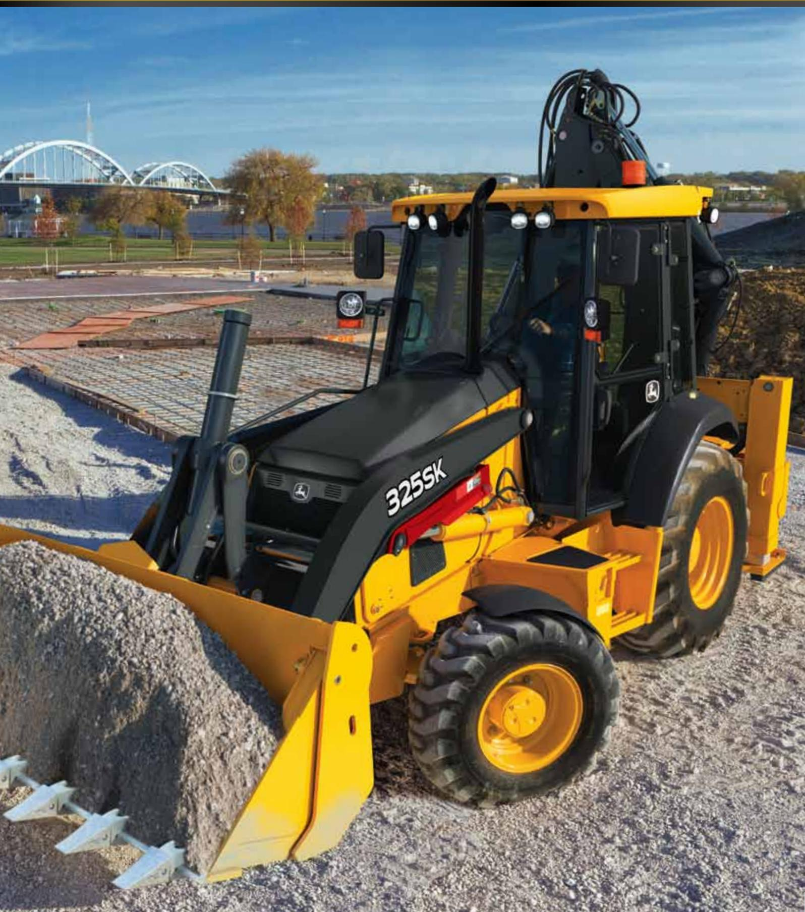
Благодаря гидравлической системе с открытым центром вне зависимости от нагрузки или сферы применения машины обеспечивается плавный отклик, точность манипуляций при одновременном использовании нескольких функций и управление, не требующее значительных усилий.
